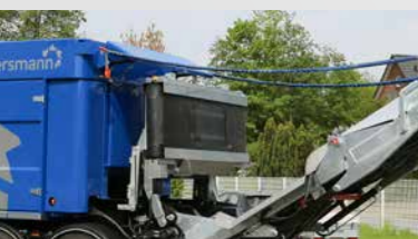
Hydraulisch verstellbarer Neodym Überbandmagnet
