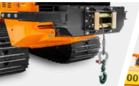
Treuil arrière avec capacité de traction de 13 t
