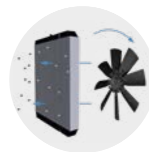
Le ventilateur réversible accroît l'efficacité du radiateur (4)
