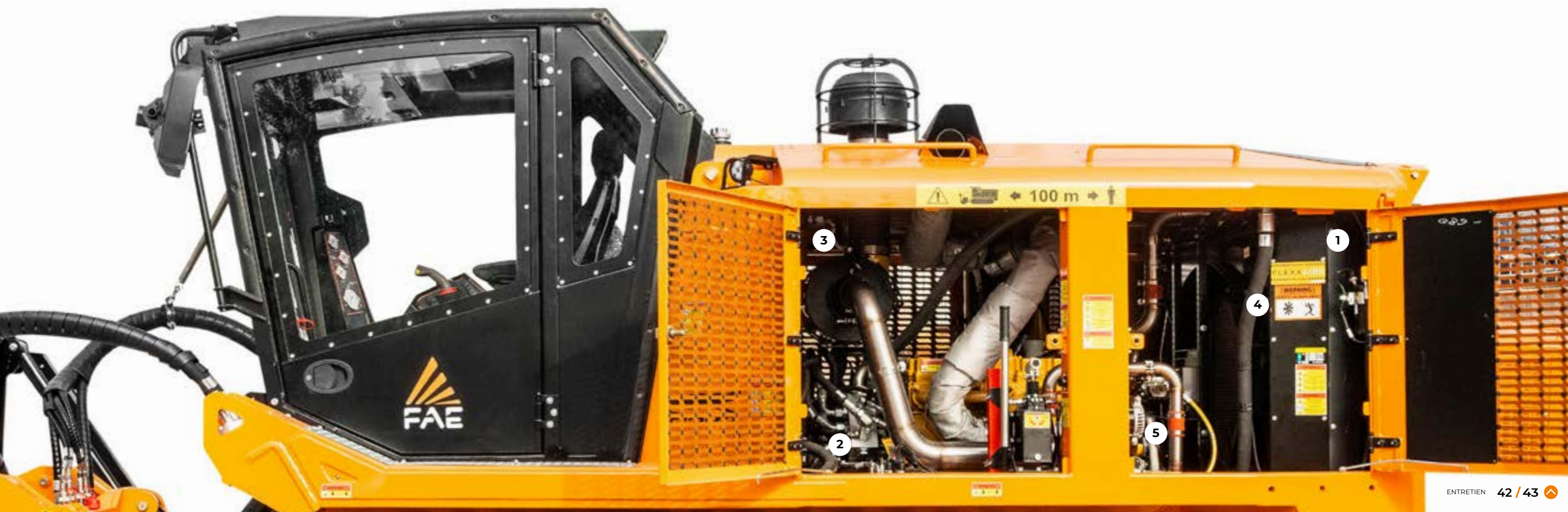
Le contrôle des niveaux est facilité par la disposition bien agencée (1)
