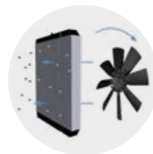
Le ventilateur réversible accroît l'efficacité du radiateur (4)
