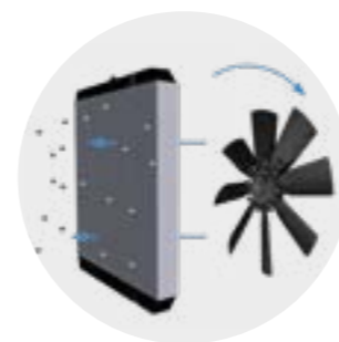
Le ventilateur réversible accroît l'efficacité du radiateur (4)
