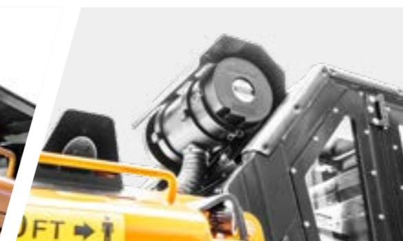
Système de pressurisation de la cabine
