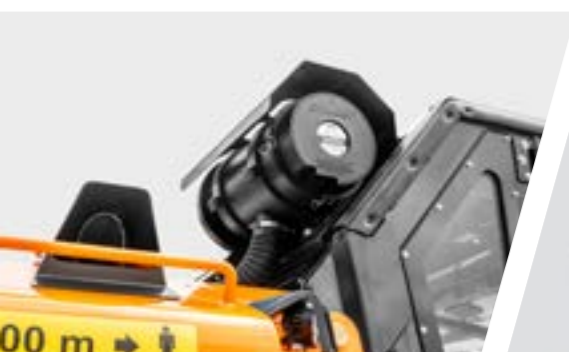
Système de pressurisation de la cabine
