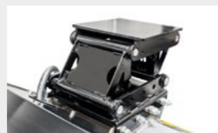
Attache basculante auto-nivelante qui s'adapte à tous les types de terrain
