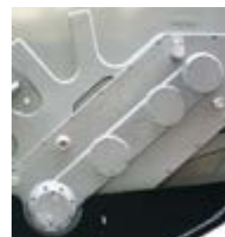
Double transmission à engrenages diminue la vitesse du rotor en réduisant l'usure des outils
