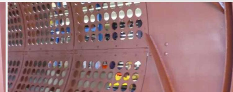
Einlauf der Trommel mit Labyrinthdichtung und Blindboden
