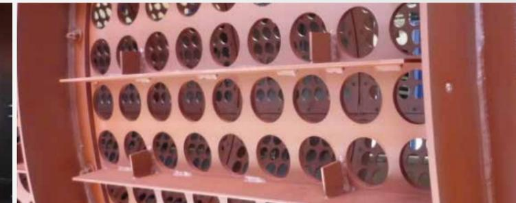
Wickelschutz durch Flacheisen
