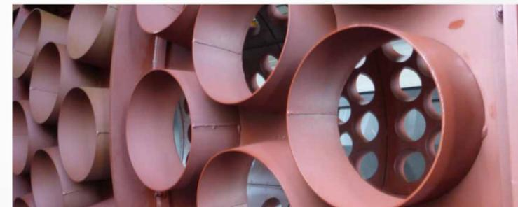
Wickelschutz durch Rohrhülsen
