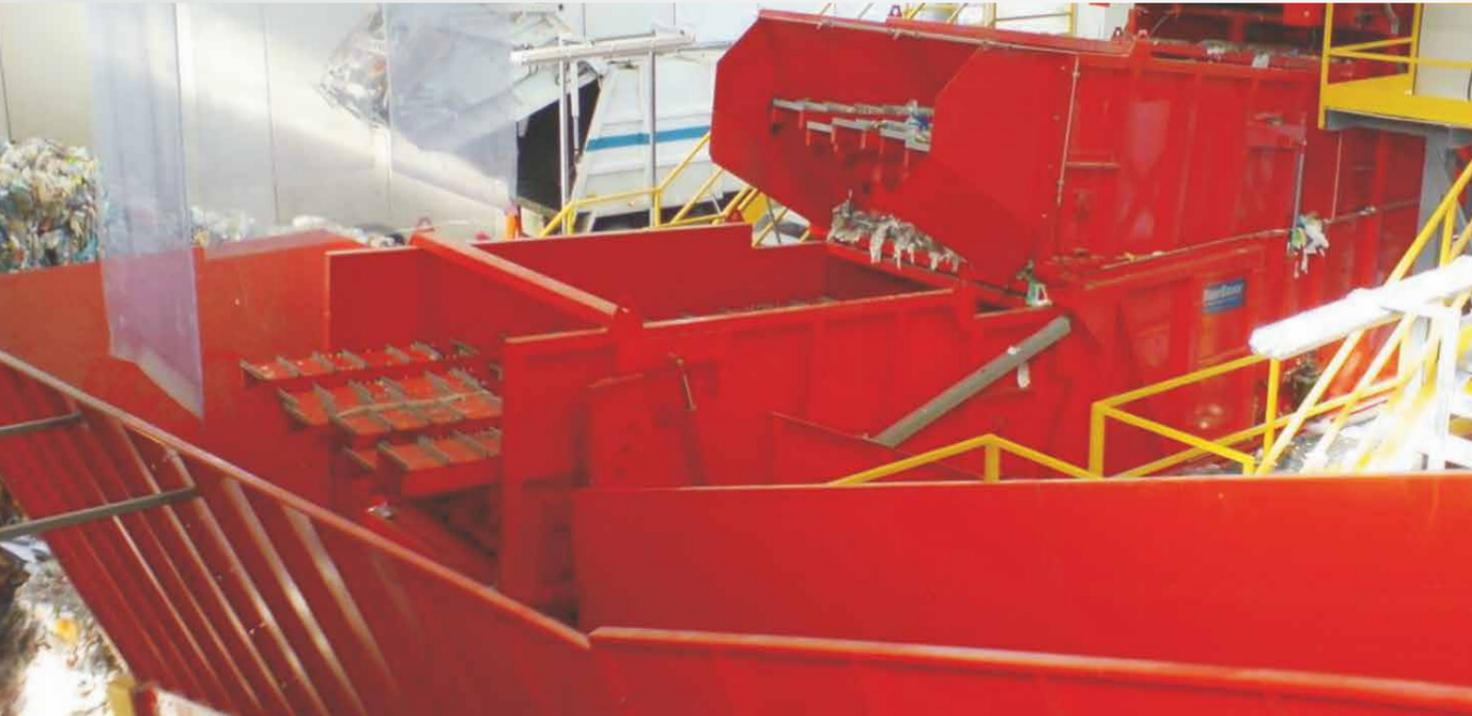
Der BSD ist ein Ballistischer Sichter für Verpackungs- und haushaltsnahe Abfälle. Die Sichtung erfolgt in nur einem Schritt. Hierbei wird das Material in eine rollende, flache und Sieb-Fraktion zerlegt, welche sich hervorragend zur weiteren Aufarbeitung eignet. Bei der Trennung von Single Stream, Commingled und DSD Abfällen ist der BSD die erste Wahl für einen effektiven Sortierprozess mit geringen Kosten und hoher Verfügbarkeit.
