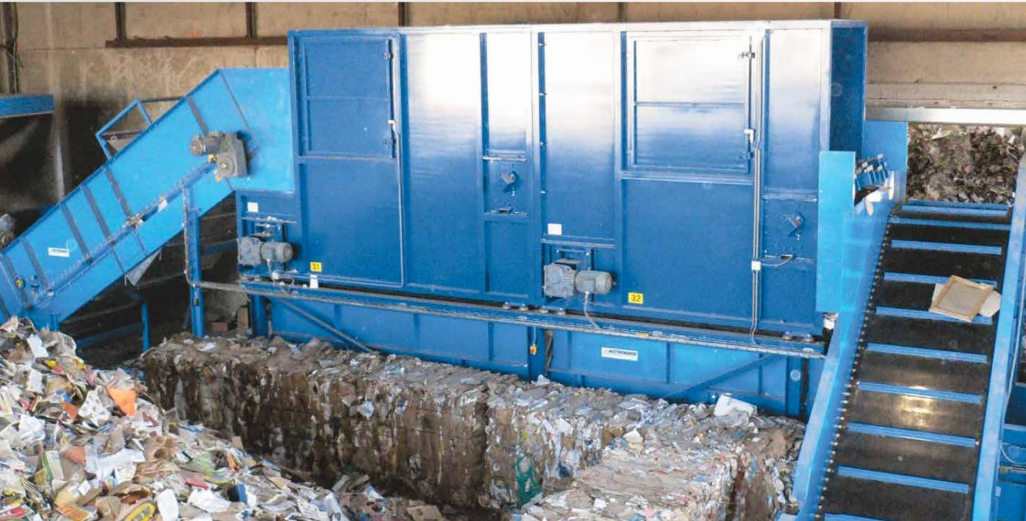
Der BPS eignet sich im Bereich der Altpapiersortierung sowohl zur Trennung von Papier und Kartonagen als auch zur Feinabsiebung der problematischen Störstoffanteile im Altpapier, hier speziell auch zur Verbesserung der Deinkingqualitäten.
